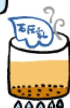
3 石灰乳を加えて加熱し、汁の中の不純物を沈殿させます。
